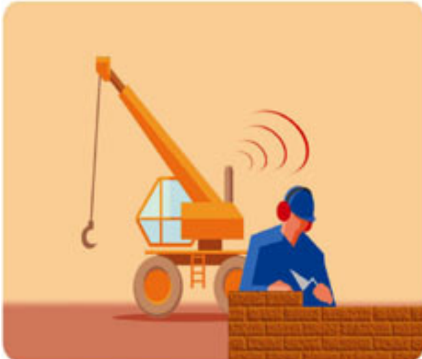
Figura 5.13 Um trabalhador com protectores auriculares montados no capacete, num posto de trabalho que exige o porte de capacete
