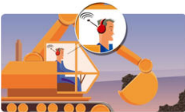
Figura 5.11 Num posto de trabalho que exige comunicação, o trabalhador usa protectores auriculares com sistemas electrónicos de comunicação.
