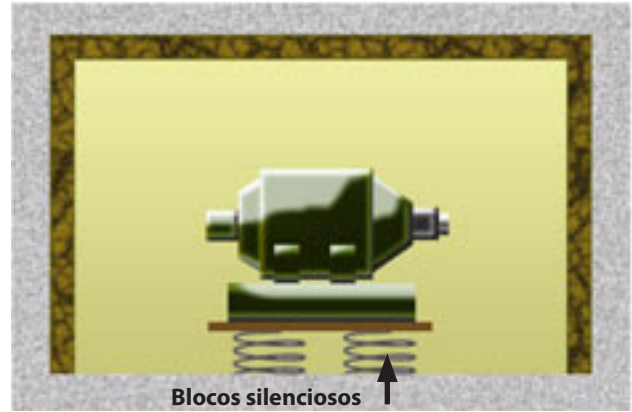
Fig. 4.14 Coloque o equipamento ruidoso em canópias insonorizadas
