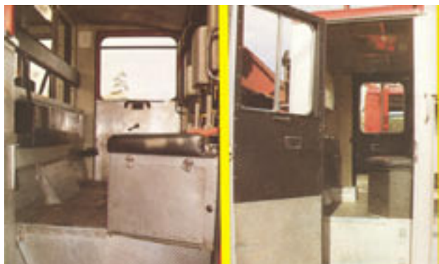
Figura 4.16 Transporte – Na cabina deste veículo de transporte rodoviário de pessoal, o ruído é reduzido revestindo o chão e as paredes laterais com fibra de vidro coberta com folha de aço e outras superfícies com material absorvente. © Health and Safety Executive, HSE, Reino Unido
