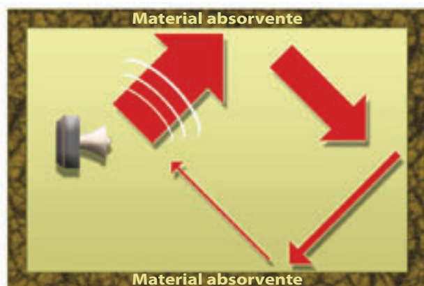
Figura 3.2: Materiais e dispositivos absorvedores reduzem o som reflectido, permitindo reduzir a influência do recinto
